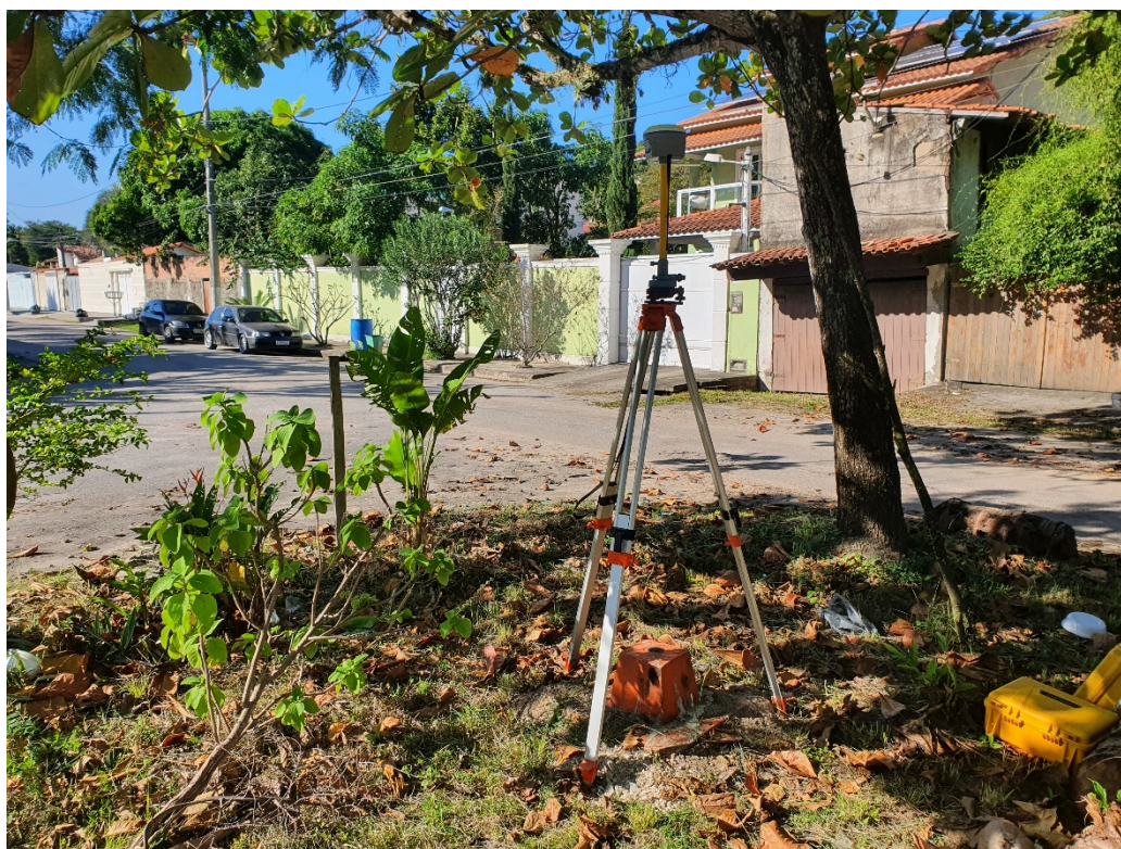
Figura 77: Definição do Marco base utilizado como referência.
