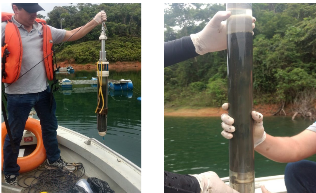
Figura 6: Amostrador Gravity Corer utilizado para amostragem de sedimento
