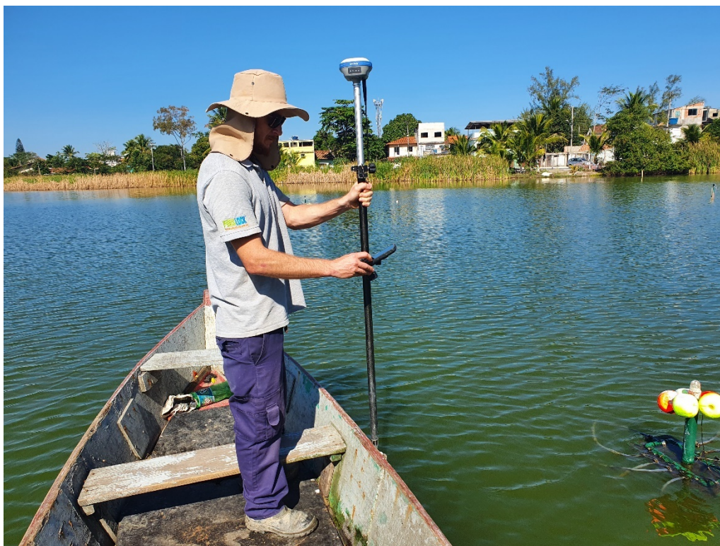
Figura 78: Aferição da altitude da camada de lodo na estaca no ponto de monitoramento em relação ao Marco.
