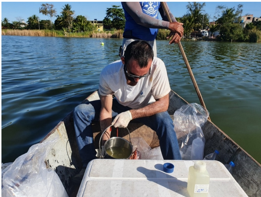
Figura 37: Transferência do material coletado com auxílio do coletor para os frascos na área das Biocaixas.
