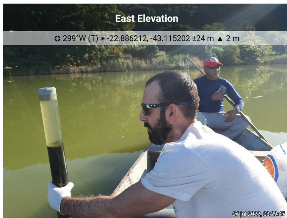
Figura 51: Coleta do material sedimentar com o auxílio do tubo cilíndrico em acrílico.
