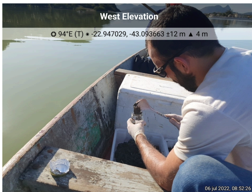
Figura 52: Transferência do material coletado para os frascos devidamente identificados.
