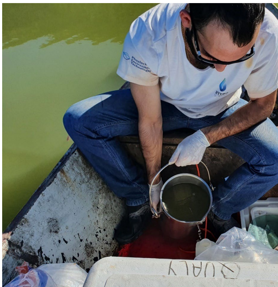
Figura 11: Transferência do material coletado com auxílio do coletor para os frascos.
